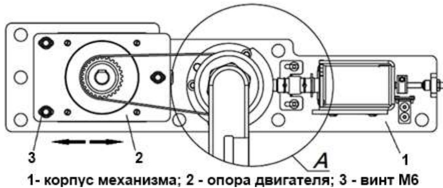
Рисунок 9 – Натяжение зубчатого ремня
